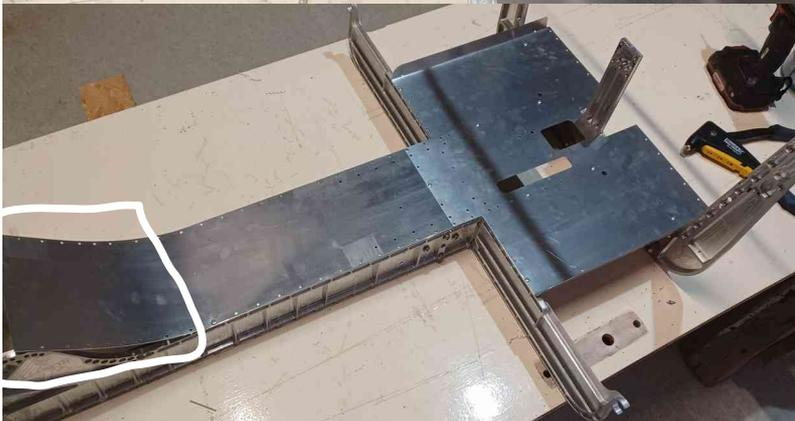
Cette zone ne doit pas être rivetée de suite, fixez les autre rivets sur **A18**
