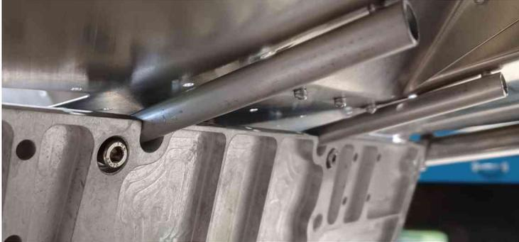
Les tubes T2 doivent se positionner dans les logements prévus. Ne les rivetez pas tout de suite.
