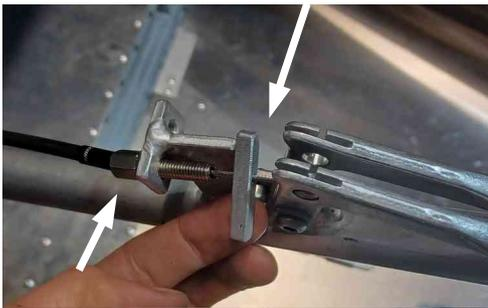
Installez les câbles de frein en n'oubliant pas pour celui de gauche, d'ajouter la goupille de frein de parking avant de l'insérer dans la gaine. Le grand côté de la goupille doit être vers le bas
