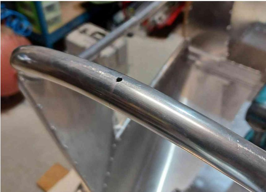
Percez un trou (taille rivet) au sommet de la partie arrière du tube **T2**
