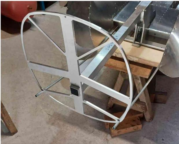
Insérez la nervure **N1** (côté usiné vers l'arrière) sur la bôme tout en insérant les 2 tubes **T4** dans les trous prévus.
