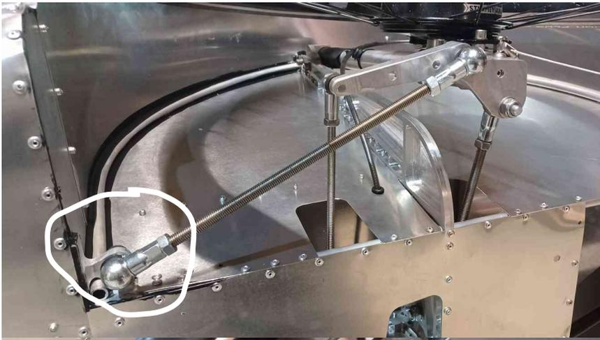
Connectez les tiges filletées avec le vélomobile. Utilisez des écrous M8F + rondelle W8 pour le tirant arrière
