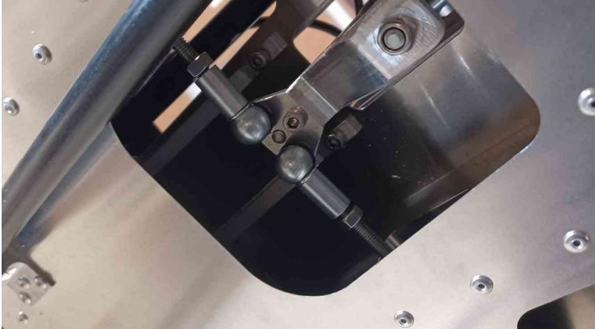
Vissez complètement les tiges filletées 6mm dans les rotules de direction
