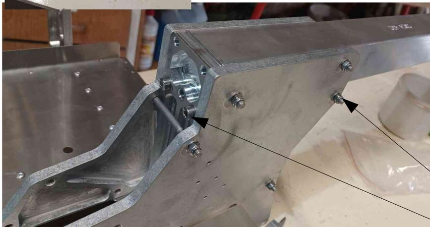
Positionnez les nervures N6 (côté usiné vers l'intérieur)
