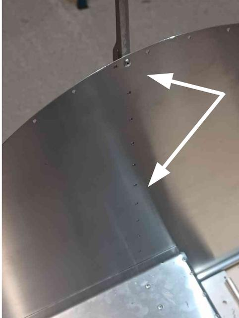
Alignez correctement la nervure principale avec les perçages verticaux, ajoutez un premier rivet puis terminez le rivetage
