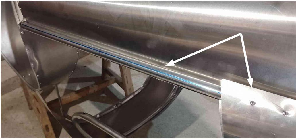
Tracez le tube en suivant l'axe des rivets déjà en place
