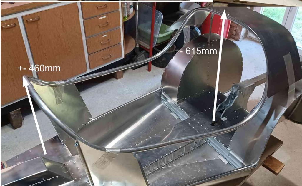
L'avant doit se trouver à **610-620mm** entre plancher et le dessus du tube
