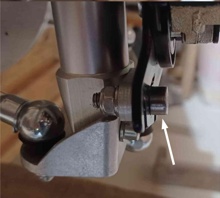
Fixez le support inférieur avec une vis R 6x20, rondelle W6 et écrou M6f
