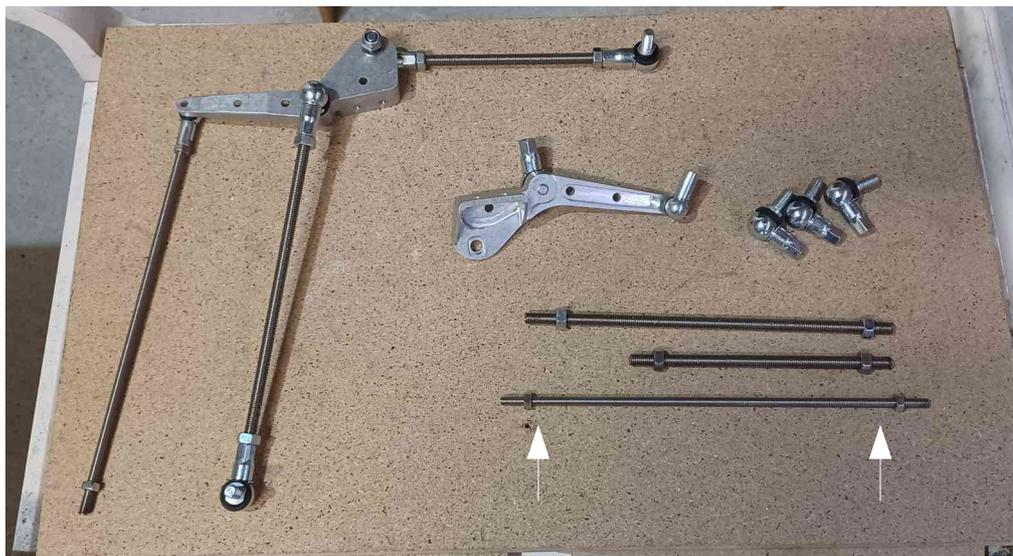
Fixez-les sur les rotules et les pattes de direction. Vissez les tiges jusqu'au bout mais sans forcer.
