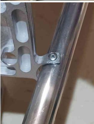
Ajoutez des rivets dessus et dessous pour maintenir le tube en position
