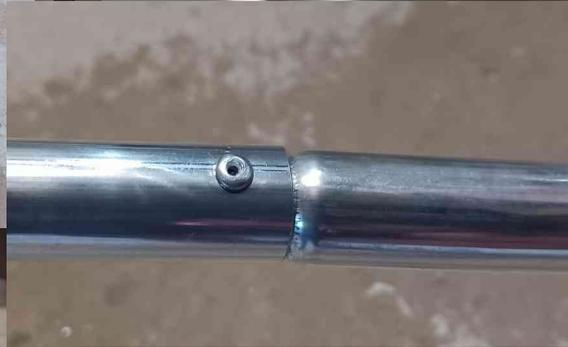
Assemblez les tubes **T1** et **T2** et ajoutez un rivet.
