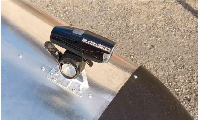
Posez le phare avant. Il est nécessaire de retirer quelques rivets avant de poser le support E4. Choisissez de préférence un endroit où 2 tôles se rejoignent pour une meilleure longévité.
