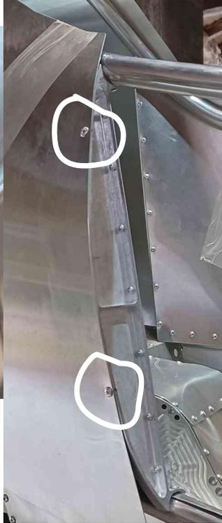
La nervure n'a pas une courbe normale, nous pouvons repérer 2 zones plus plates et c'est à cet endroit que 2 rivets doivent être posés.
