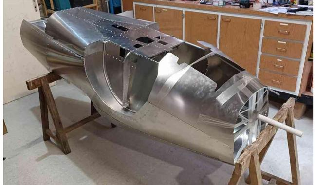
Plaquez la tôle avec du ruban adhésif puis ajoutez un rivet pour maintenir la position. À la main, courbez la tôle autour du tube
