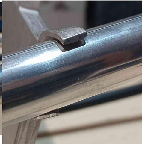
Le support arrière doit être légèrement plié pour s'adapter à l'angle du tube
