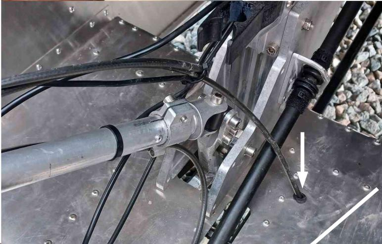
Passez les gaines de frein dans les passe-câbles du plancher.
