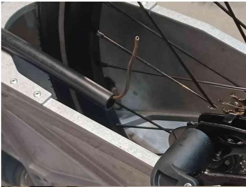
Préparez la chaîne (défaites les noeuds) et insérez un fil de fer dans le tube **Tp3**.
