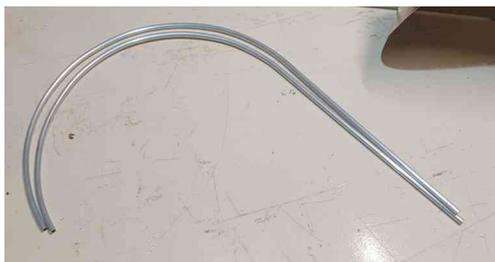
Les tubes **T5** forment le côté extérieur du passage de roue. L'ajustement va demander une attention particulière. L'objectif est de suivre le bord de la tôle, cette fois-ci dans les 3 dimensions !
