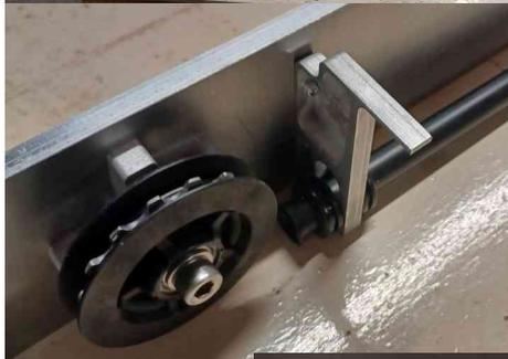
Fixez **N12** derrière la roulette, le haut doit être aligné avec le haut du cadre.
