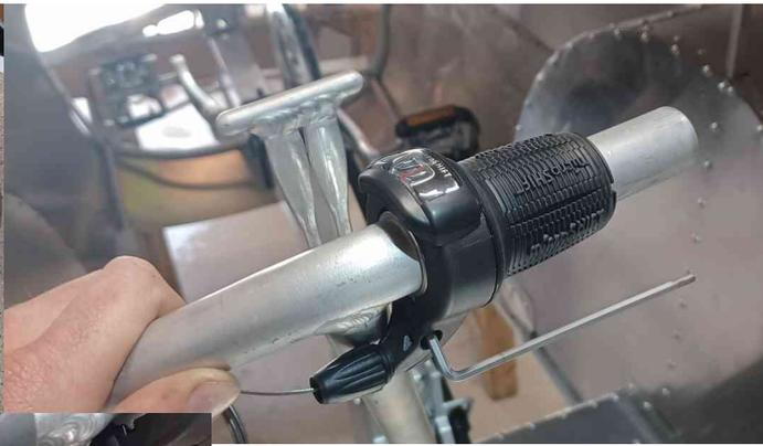
Installez la commande de dérailleur. La sortie de câble doit être en dessous du guidon.
