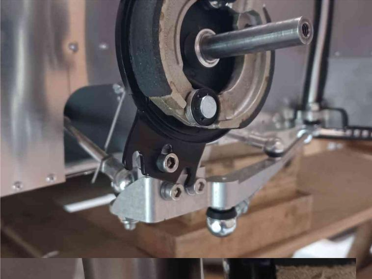
Insérez la plaque de frein sur la fusée de roue.
