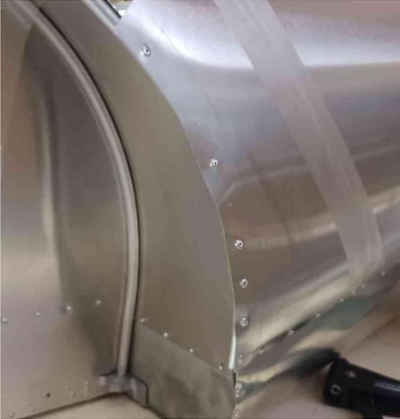
Fixez quelques rivets en bas du passage de roue en maintenant 30mm d'écart
