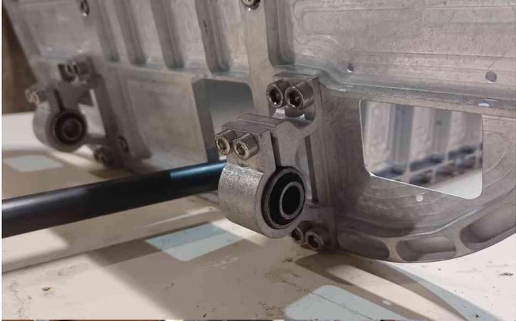
Fixez les support **F10** solidement avec du frein filet, graissez puis placez les silent-blocs **F9** sans les serrer pour le moment.
