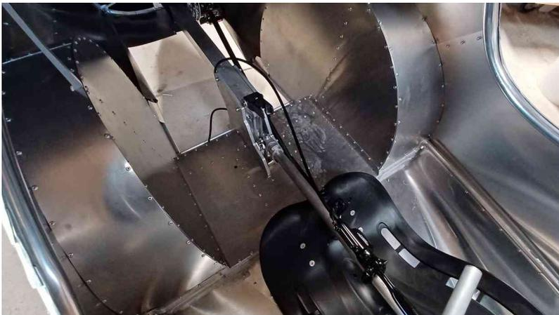
Ajustez la position du siège et du pédalier à votre morphologie, serrez les bagues du support pédalier fermement puis posez l'arrière du vélomobile sur une cale.
