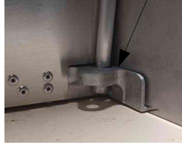
Les tubes sont pré-cintrés, mais il faut terminer l'ajustement à la main. Cette étape est minutieuse, prenez votre temps et procédez par petites corrections, de façon à approcher progressivement la forme exacte
