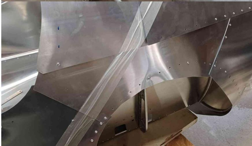
Au moment de riveter la partie centrale, faites attention à ne pas trop appuyer sur la tôle pour conserver une forme convexe
