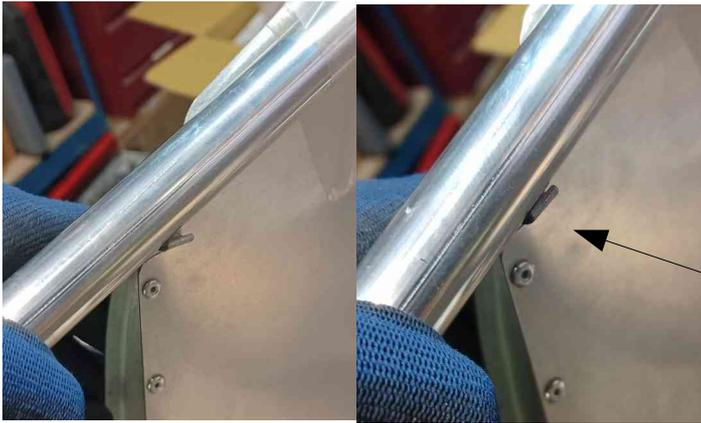
Les extrémités des supports **N8** doivent être légèrement pliées pour s'ajuster au tube
