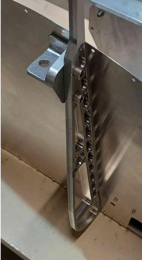
Fixez fermement les supports F3 du train avant en utilisant du frein filet et les rondelles.
