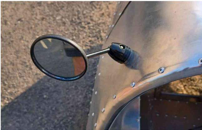
Posez les rétroviseurs. Si vous souhaitez ajouter un capot rigide, la base du rétroviseur doit être à 10 cm du bord. Utilisez des rondelles W8RL de chaque côté de la tôle.
