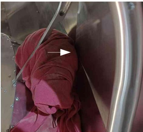
Par l'intérieur, placez un chiffon enroulé pour maintenir une pression contre la tôle et permettre d'obtenir une forme convexe régulière.
