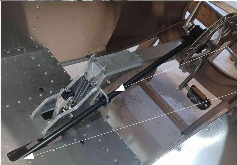
Positionnez le tube **Tp1** (60cm) avec les caoutchoucs de part et d'autre du guide **E7**.
