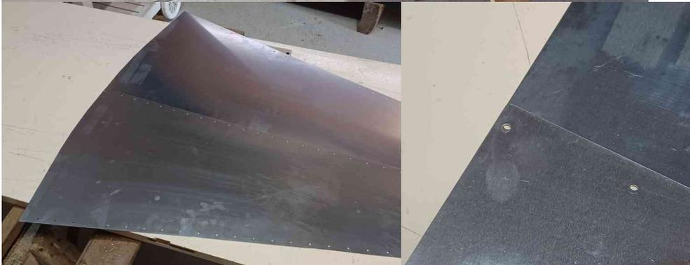
connectez les tôles **A21**. Le bon côté à riveter est celui dont les trous vont jusqu'au bord de la tôle.
