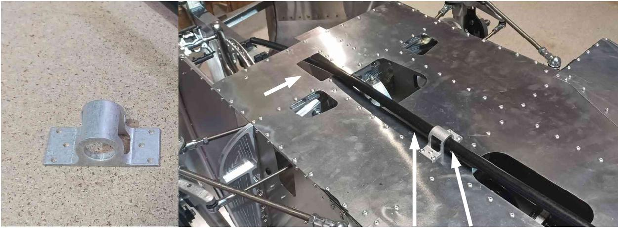
Posez le support **E3** puis insérez le tube **Tp3** (150cm). Il doit s'arrêter à environ 10cm de l'axe de la roue arrière.
