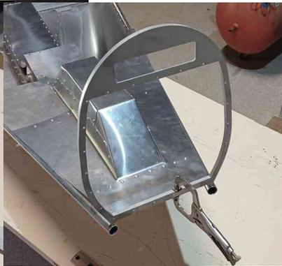
Avant de positionner les tubes, fixez la nervure **N2**, elle va ensuite guider les tubes dans la bonne position.
