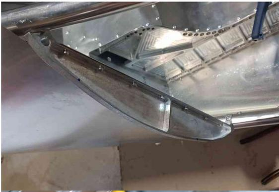
Les nervures **N8** peuvent ne pas être parfaitement alignées avec la tôle, ajustez-les à la main si nécessaire.
