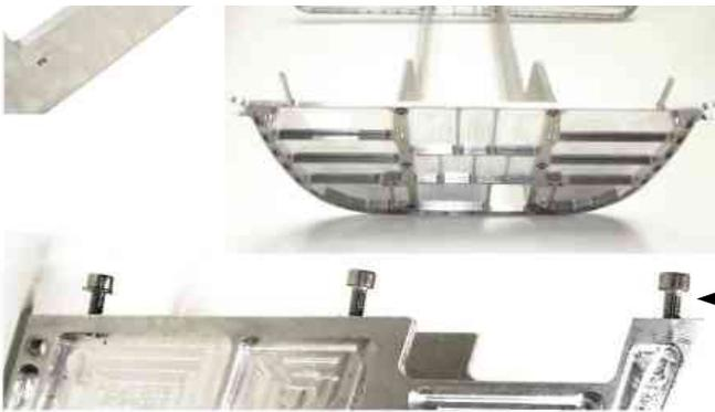
Boulonnez la face arrière **N10** avec les vis R 5x10
