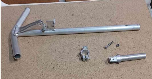
Préparez le guidon **D1**, insérez le collier **D3** avec vis R 6x16, insérez le manchon **D2** et fixez l'ensemble sur le vélomobile, utilisant une vis R6x35 et écrou M6F
