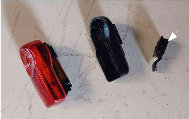
Défaites le cache du feu arrière et retirez le crochet (une petite languette est à soulever avec un tournevis plat).
