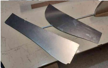
Les tôles **A5** sont à fixer sur l'arrière du passage de roue, l'encoche permet de positionner correctement l'ensemble.
