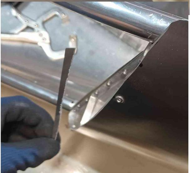
Découpez proprement la tôle qui dépasse de la nervure
