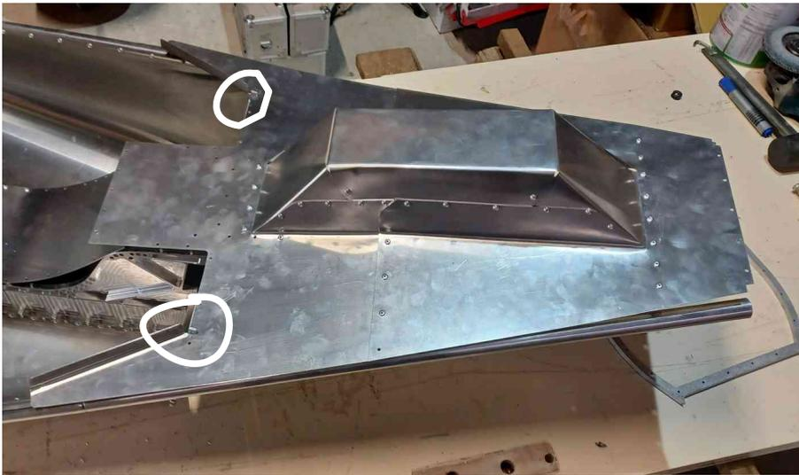
Positionnez l'ensemble sur le chassis, les encoches le tiennent dans la bonne position.
