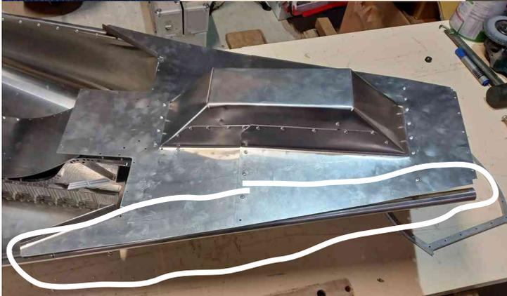
Vous pouvez maintenant terminer le rivetage le long des tubes. Selon la version de votre kit, les trous sont à percer, un écart de 4 cm est convenable
