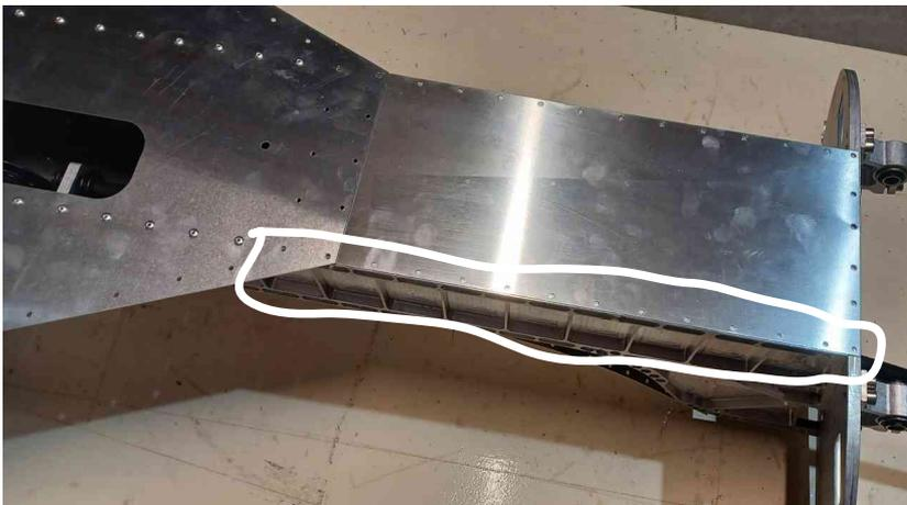
Positionnez La tôle **A3** dessous la Tôle **A4**
