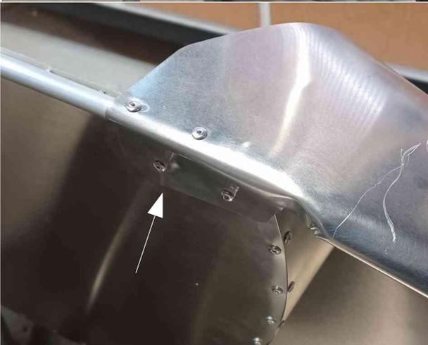
Repliez le bord des tôles contre les passages de roue et ajoutez 2 rivets
