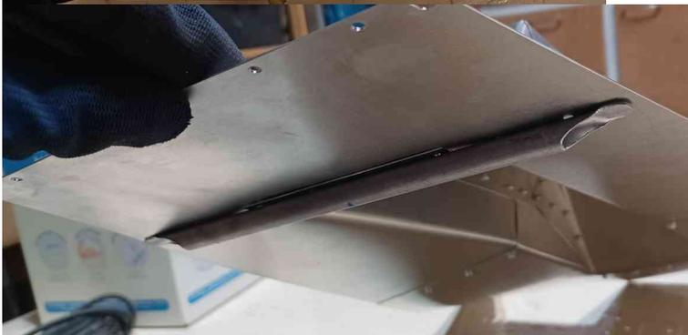
Le tube doit être fixé par dessous, le marquage va vous aider à trouver la bonne position. Fixez les rivets.
