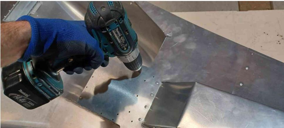
Terminez le rivetage des tubes **T14** puis continuez à riveter la tôle sur la nervure **N10**, pendant le perçage, respectez l'angle de la nervure. Autrement le foret risque de glisser
