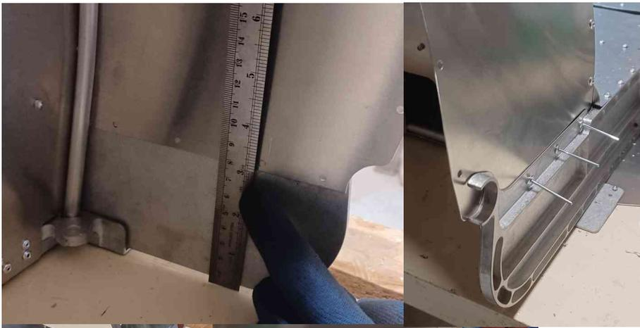
Avant de fixer l'arrière du passage de roue, vérifiez que la tôle soit bien à l'horizontal
