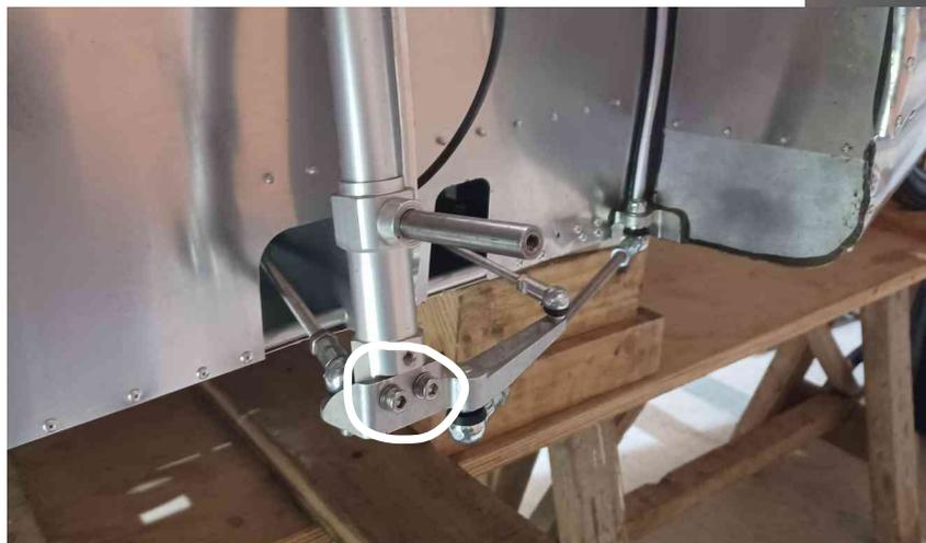
Fixez la patte de direction à la suspension avec deux vis R6x16 + rondelle W6, ajoutez du frein-filet
