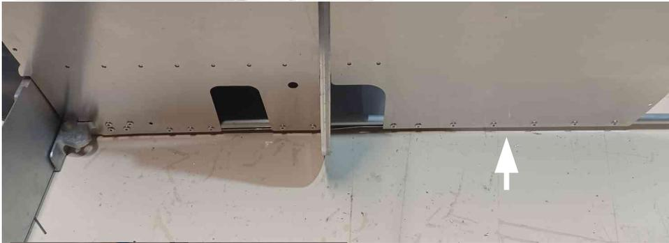
Rivetez d'abord le bas avec quelques rivets
