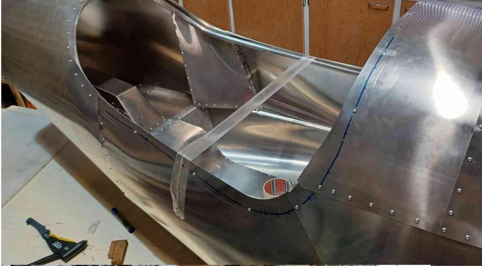
Tracez les repères de perçage autour de l'ouverture, prenez un écart de 30 mm entre chaque rivet
