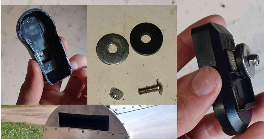
Faites un trou au fond du cache et insérez la vis. P5x16
