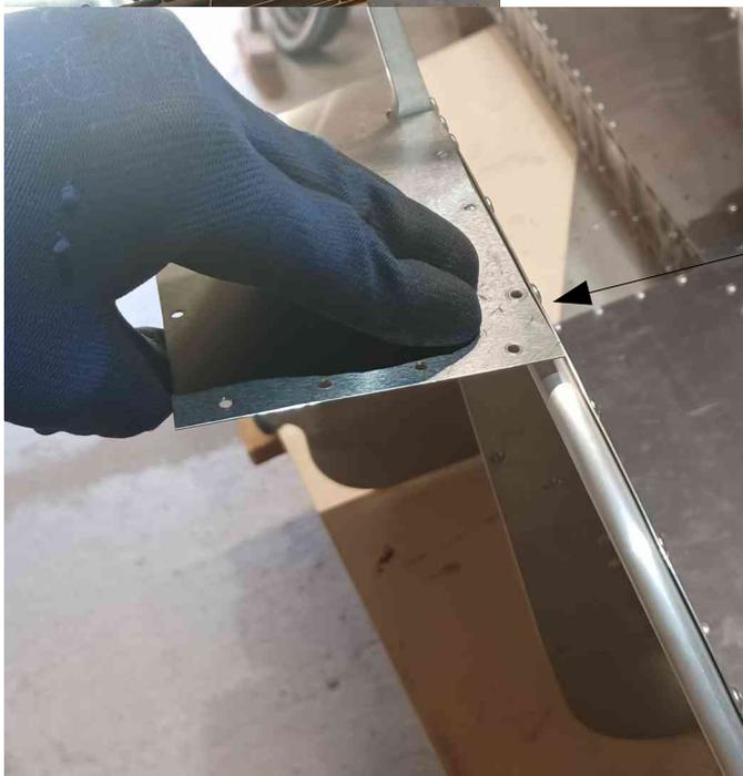
A l'autre bout, il faut redresser un peu la tôle pour que les trous soient bien en face du tube.
