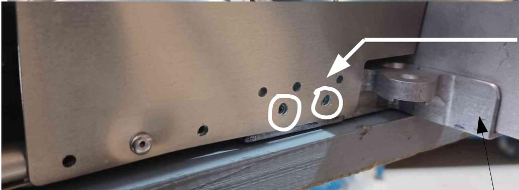
Ajoutez 2 rivets pour fixer la tôle, F4 et le tube T4 ensemble
