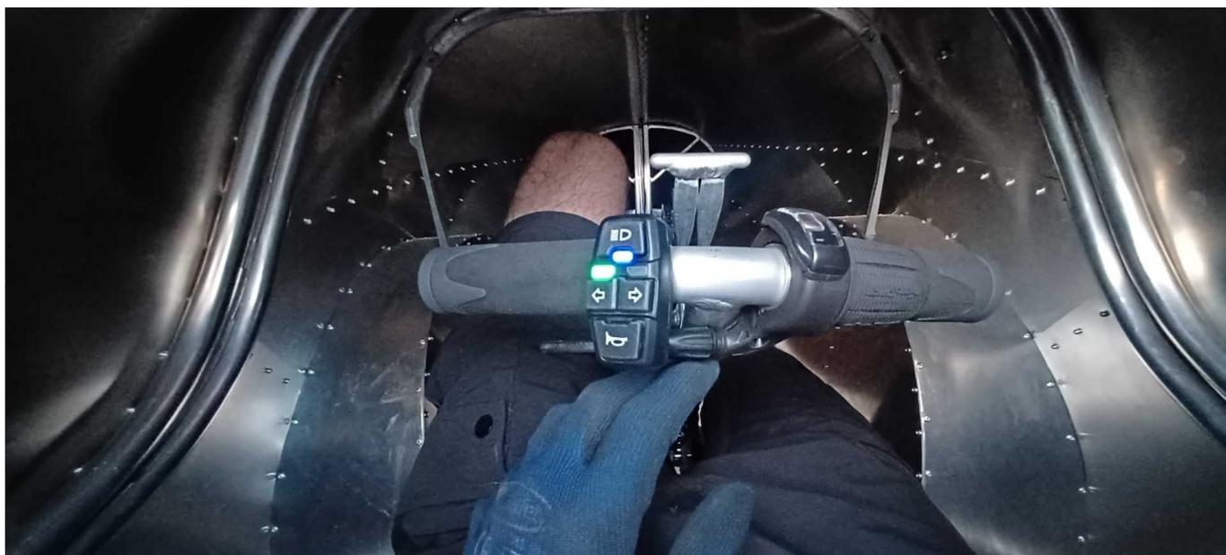
Si le bruit du buzzer vous semble excessif ou désagréable, ouvrez le boîtier et entourez-le avec un morceau de velcro. Parfois, le bruit désagréable vient du contact entre le buzzer et le boîtier en plastique.
