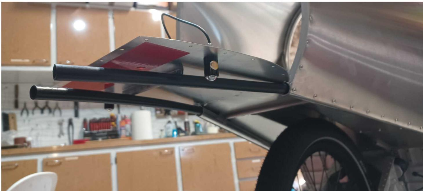
Le phare arrière est à fixer avec l'adhésif double-face fourni. Vous pouvez aussi utiliser les deux vis fournies si nécessaire.
