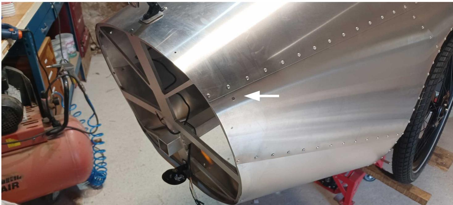
Installez les clignotants avec l'optique tournée vers l'avant. Fixez-les avec les écrous M6 fournis, serrez fermement et utilisez du frein filet.
