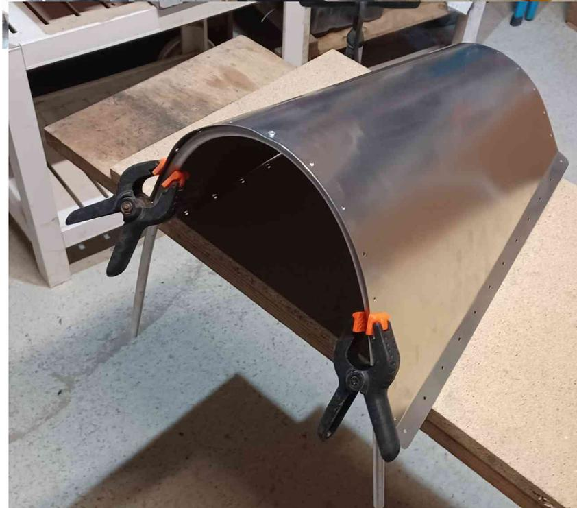
Fixez la tôle avec un premier rivet au sommet du tube T22. Alignez le soigneusement avec les autres trous et fixez les rivets.
