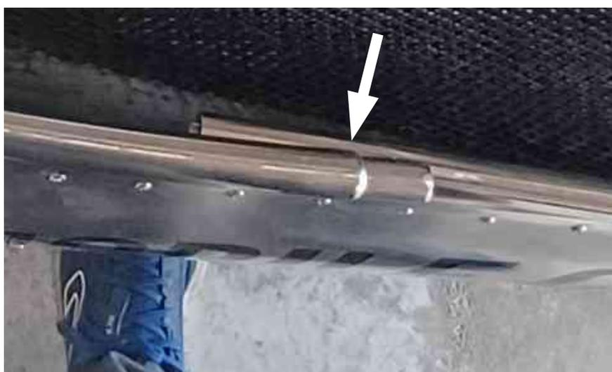
Faites une marque ici sur le tube T20 en face de la réduction du tube 21
