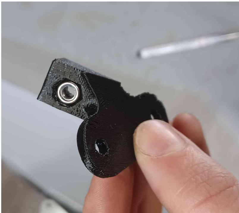
Insérez les écrous M5f dans les supports H2, si besoin, chauffez rapidement le trou avec un briquet pour faciliter l'introduction de l'écrou
