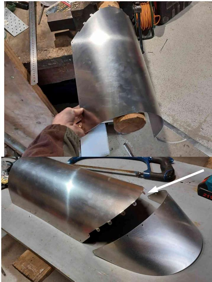
Préformez les deux tôles A24 et A25 puis pliez légèrement les languettes selon l'angle de l'assemblage
