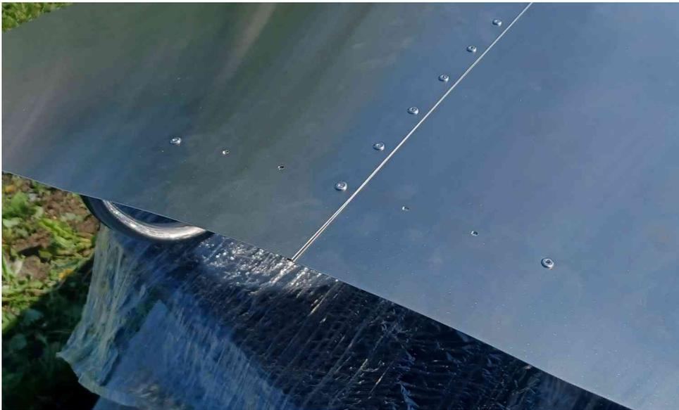
A l'avant, fixez les rivets au niveau des trous déjà percés.
