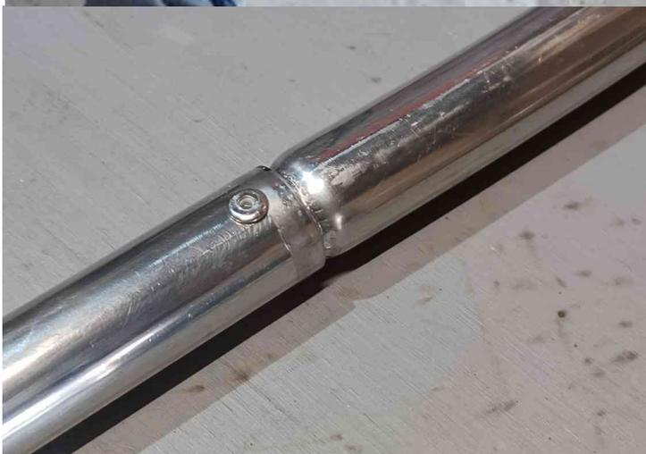
Présentez à nouveau l'ensemble sur le vélo, vérifiez la cote de 83 cm et rivetez les tubes entre-eux.
