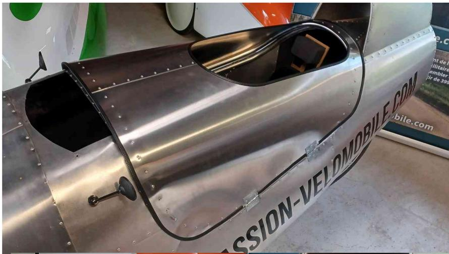
Posez soigneusement le profil de protection du bord de tôle J1, autour de la tête et autour du capot.
