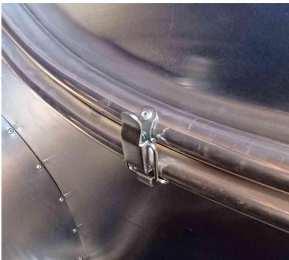
Fixez le fermoir à levier en plaçant le crochet côté vélomobile et le levier côté capot.
