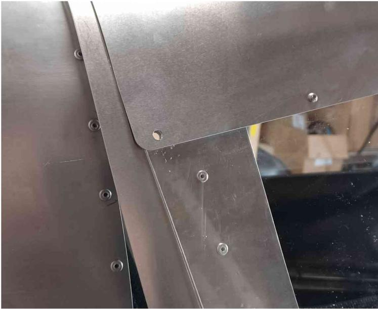
Retirez la vis M3 qui se trouve à l'arrière du toit. Percez à 5mm au travers le support arrière et fixez une vis P5x10 avec écrous M5f
