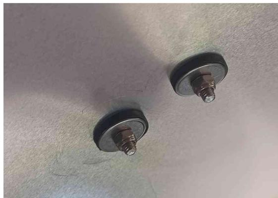
Percez et fixez-les avec 4 vis P5x15 en ajoutant par dessous une rondelle W6RM, W5L et écrous M5f
