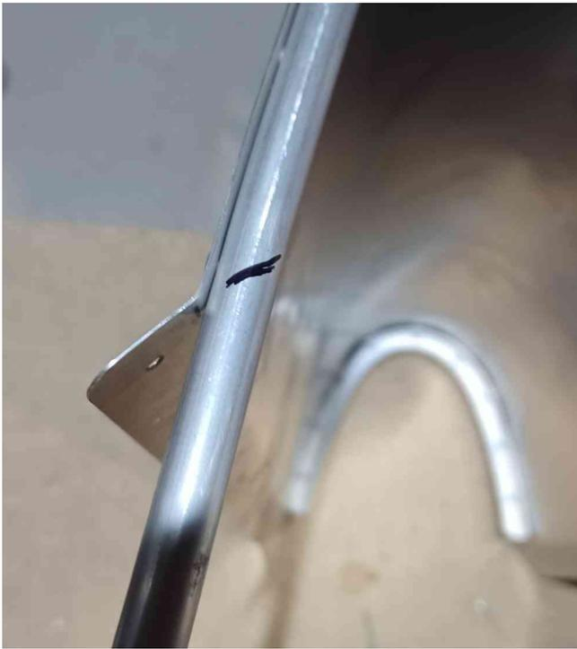
Faites de même avec le tube T22. Présentez le coqueron et ajustez la coupe si nécessaire. Pensez à ébavurer les tubes après la coupe.
