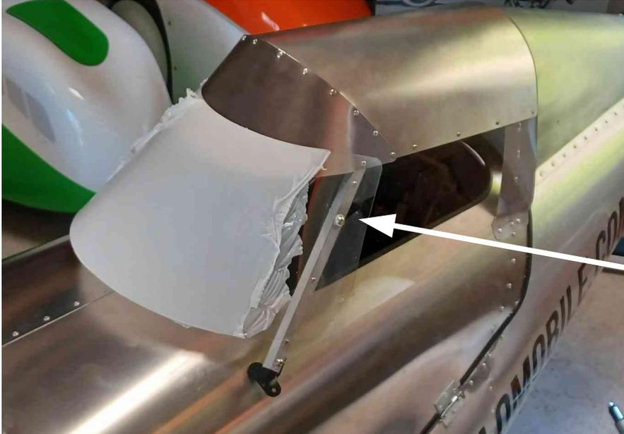
Fixez la visière V1 avec les vis P5x10 et écrous M5f en ajoutant deux rondelles nylon en surépaisseur entre la visière et le profil
