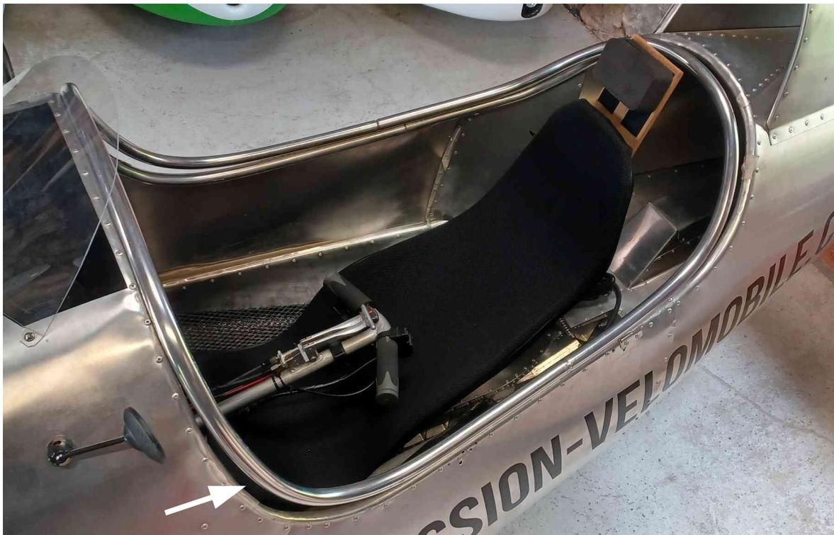
Ici le tube est correctement ajusté, ce n'est pas grave si il y a un écart au niveau des courbes.
