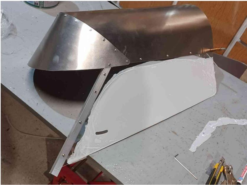
Ajoutez les vis L3 et écrous M3 dans les perçages de 3,3mm
