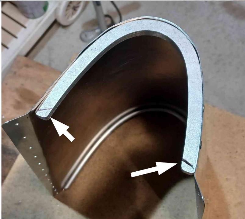
Il est nécessaire de recouper les extrémités pour éviter le contact avec le vélo
