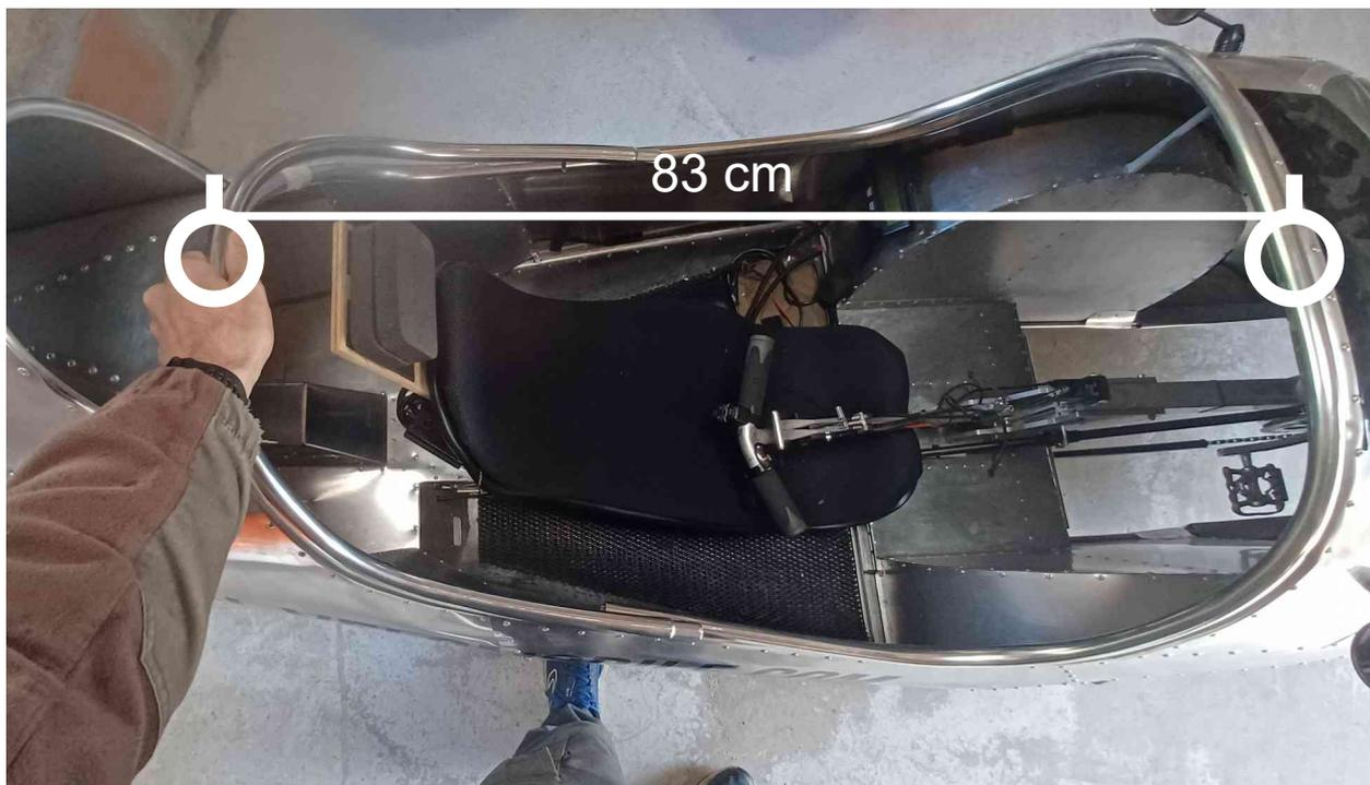
Faites la même opération avec le tube arrière T21, il y a normalement moins d'ajustement à effectuer.
