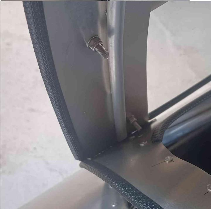
Ajoutez les protections de tôle J1 sur la partie arrière du support et en bas des vitres latérales
