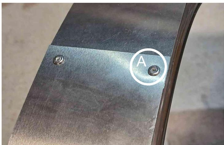
A l'arrière, l'emplacement du rivet A est à percer en fonction du tube.
