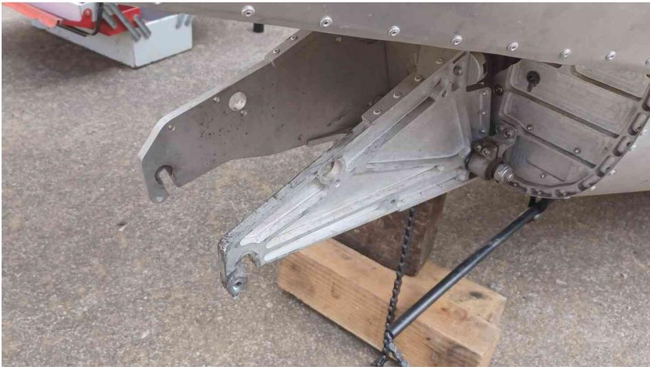
Commencez par démonter la roue d'origine. Reposez l'arrière sur une cale en bois.
