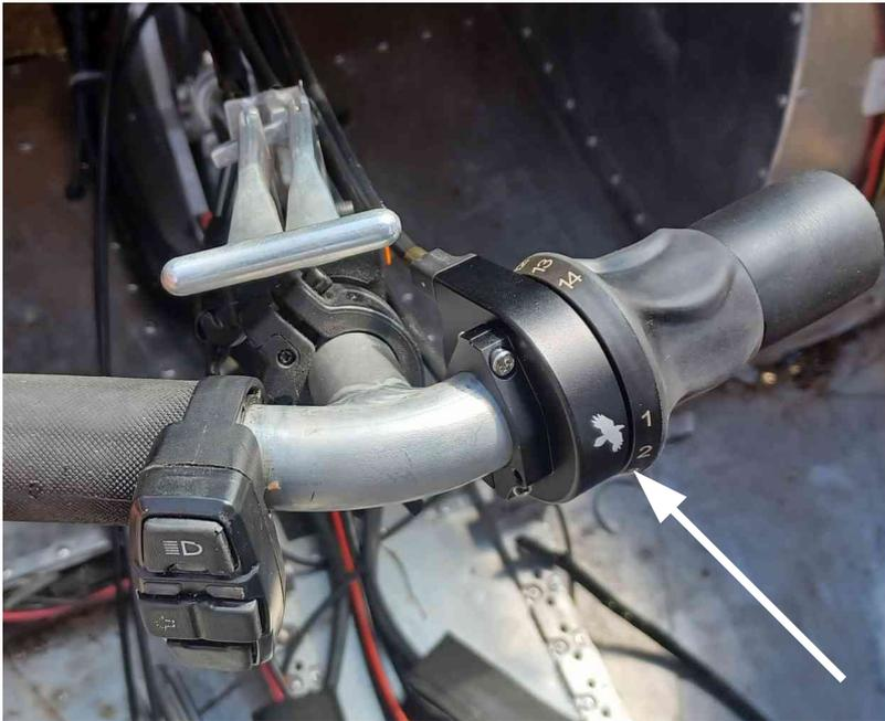
Insérez la poignée tournante et fixez-la à l'emplacement qui vous convient avec les deux vis de serrage.
