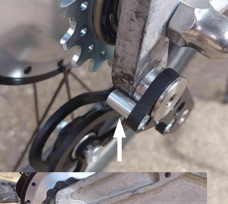
La butée du tendeur vient prendre appui contre l'encoche de la fourche.
