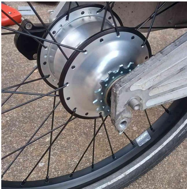
Après avoir remonté le fond de jante, le pneu et la chambre à air, mettez en place la roue Rohloff en plaçant le pignon côté droit du vélo.
