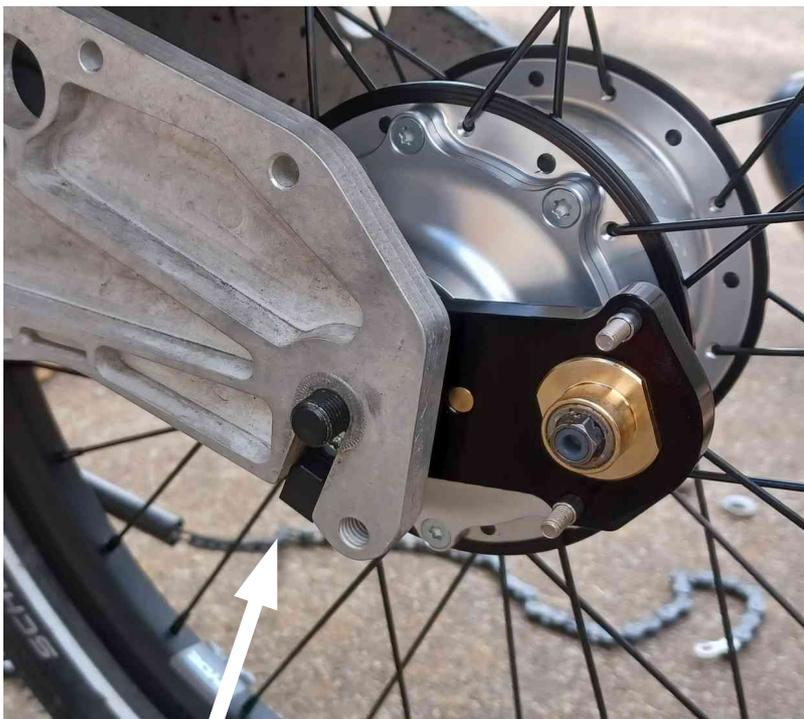
Côté gauche, le torq arm s'insert dans la fente de la fourche.
